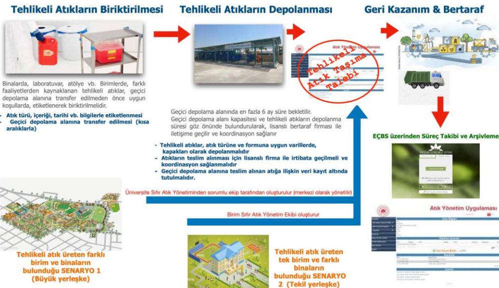
Şekil 9. Tehlikeli atıkların geçici depolama alanına transferi iş akış süreçleri diyagramı
